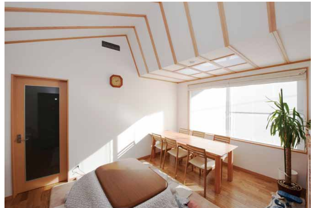
▲南向きのリビング。9時からソーラーシステムのスイッチを入れて、取材時(1月上旬)の13時にも20度の暖かさをキープ。中央の時計の上に温風の吹き出し口がある。「自然の暖かさなので、生まれたばかりの赤ん坊を連れて里帰りしている娘も安心して過ごせます」(黒澤さん)
